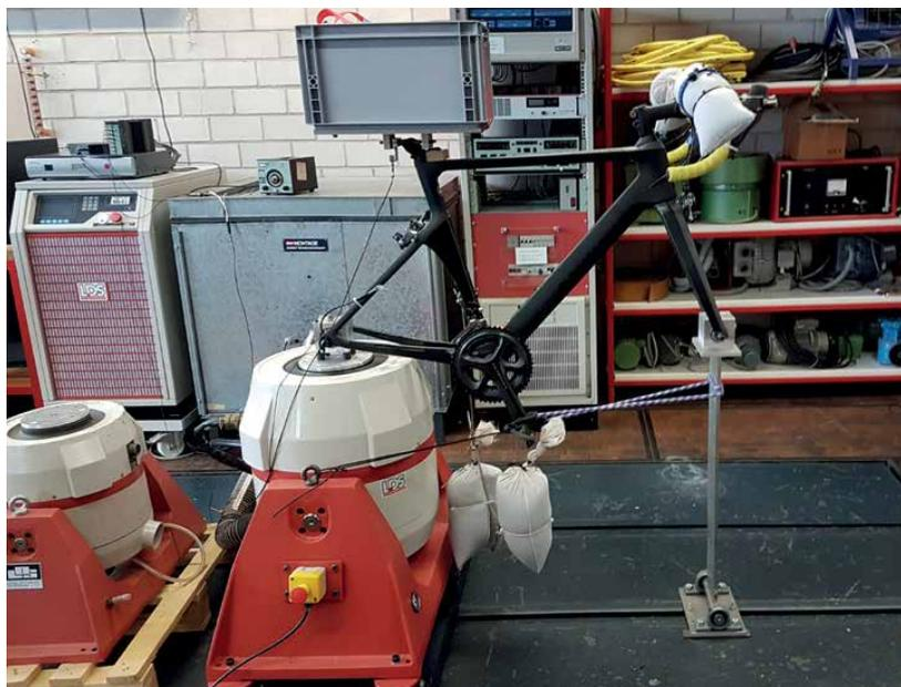
Abb. 1: Versuchsaufbau Shaker: Rennradrahmen mit Schwabbelmassen und Messtechnik
