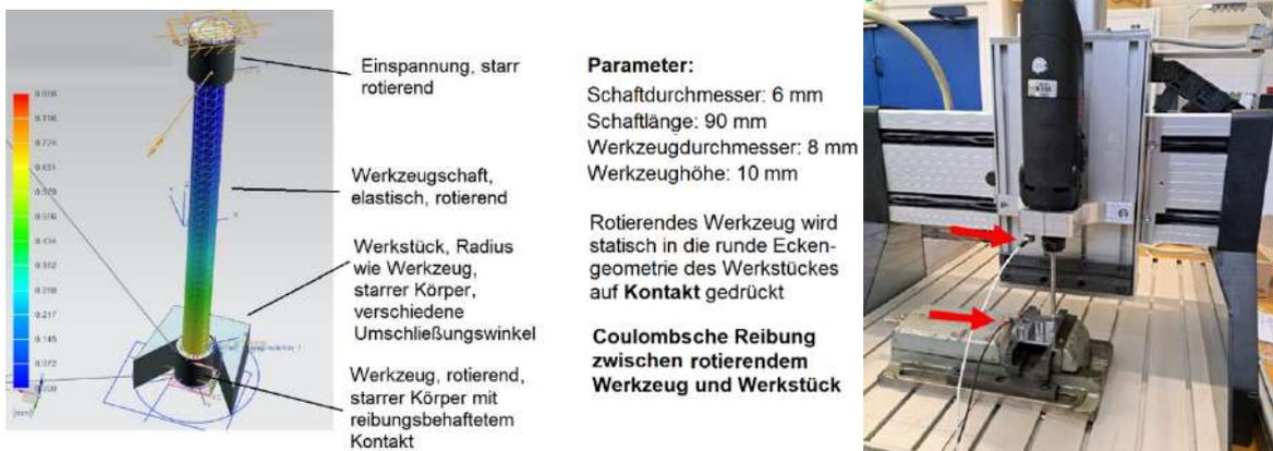
Abbildung 3. Elastisches MKS-Modell zur Stabilitätsuntersuchung beim Taschenschleifen und Portalfräse
