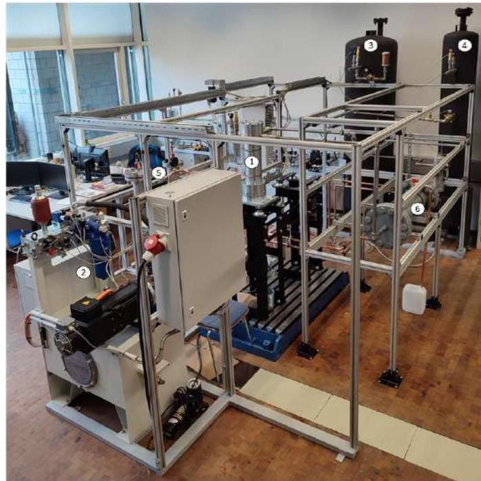
**Abbildung 4. Prüfstand zur Quasi-Isothermen Verdichtung: (1) Zylinder mit Verdrängerkolben, (2) Hydraulikaggregat, (3) 16 bar Niederdruckspeicher, (4) 50 bar Hochdruckspeicher, (5) Flüssigkeits-Einspritzsystem, (6) Kühlkreislauf mit Wärmeübertrager**
