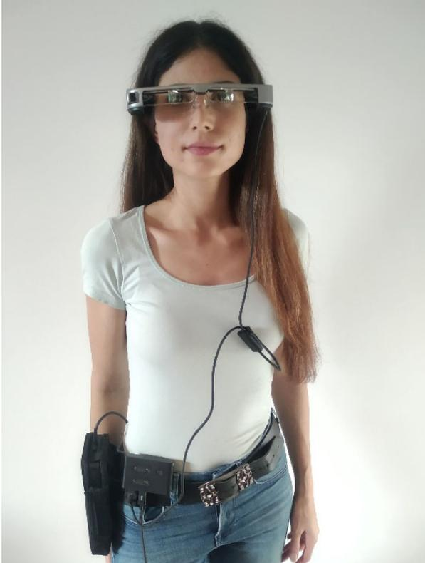
*Abb. 29: Binokular transparentes HMD (Dynabook/Toshiba DE 100 Mini-PC mit Epson Moveo BT35E)*
